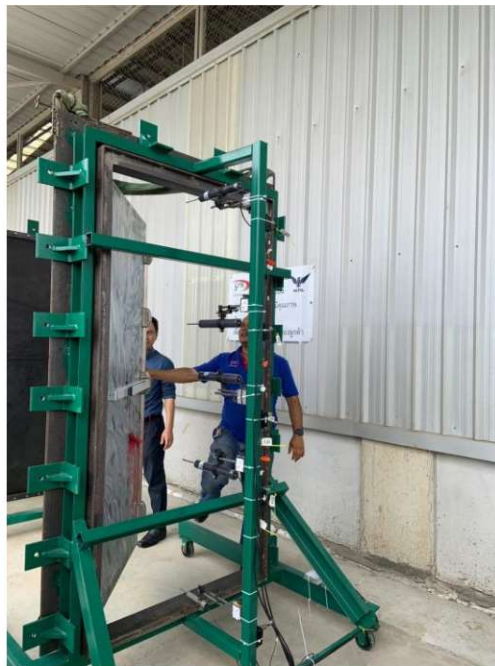
รูปที่ 3 ตรวจสอบการเปิด-ปิดประตูหลังทำการทดสอบ
