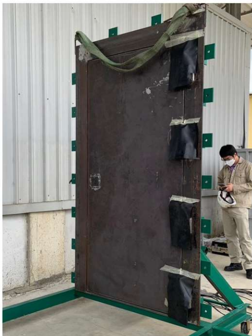
รูปที่ 4 ตรวจสอบร่องรอยความเสียหายของประตูหลังทำการทดสอบ
