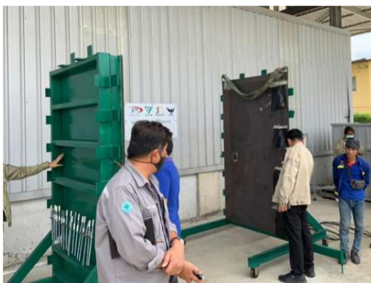
รูปที่ 3 ตรวจสอบการเปิด-ปิดประตูหลังทำการทดสอบ
