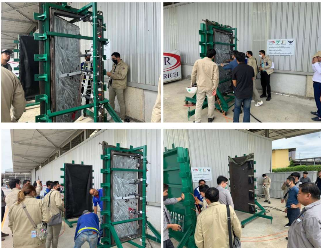
รูปที่ 8 การตรวจสอบประเมินระดับความเสียหายของบานประตูหลังการทดสอบ
