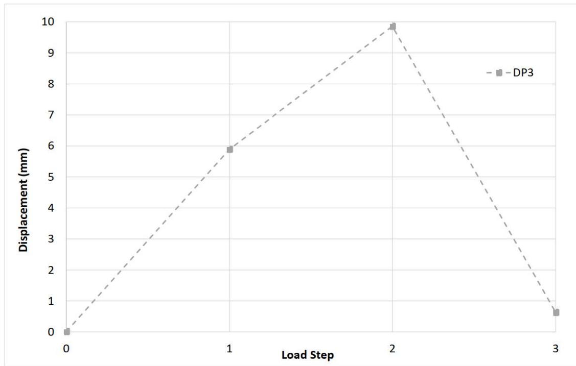
กราฟที่ 3 ค่าการแอ่นตัวของตำแหน่งวัด DT3 ที่ระดับแรงดันค่าต่างๆ
