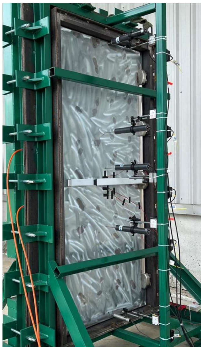
รูปที่ 6 การติดตั้ง Displacement sensors
